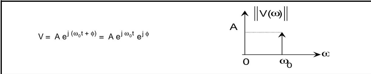
La figure de droite représente le module du complexe en fonction de la pulsation  $\omega$ , aussi appelé représentation spectrale du signal. Bien que cette représentation ait ici peu d'intérêt, elle permettra d'introduire des notions plus élaborées.
